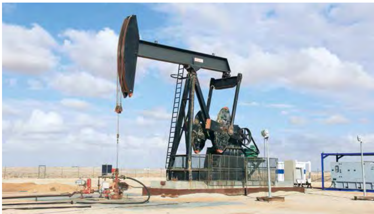
Salah satu pompa angguk Perseroan di aset baru Bir Ben Tartar, Tunisia One of the Company's beam pumps in the new Bir Ben Tartar asset, Tunisia
